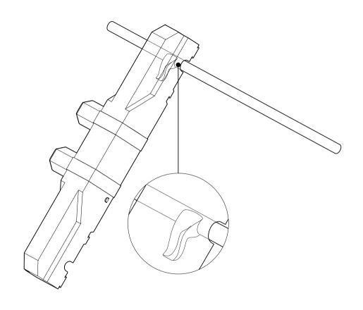
PUSH THE HEAD END OF THE MOTOR ONTO THE DRIVE BAR ENCLOSING THE DRIVE HOOK
